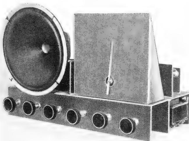
Frontansicht mit Skalenträger und Bedienungsknöpfen. Reihenfolge der Knöpfe von links nach rechts: Lautstärkereger, Klangregler, Sende-Empfangsschalter, Rückkopplungsregler, Wellenschalter und Abstimmknopf
